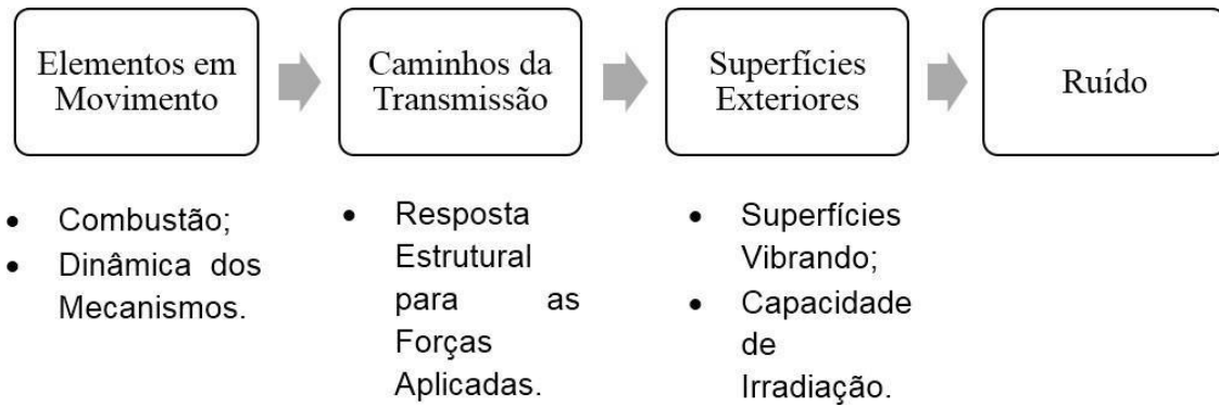
Figura 3. Diagrama de blocos do modelo de geração de ruído do motor
